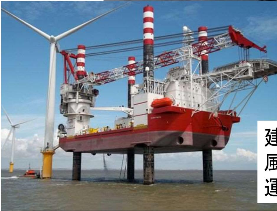
建設専用船(Jack Up Vessel)に風車部材を搭載して、建設サイトまで運んで、クレーンで組み立てる。
