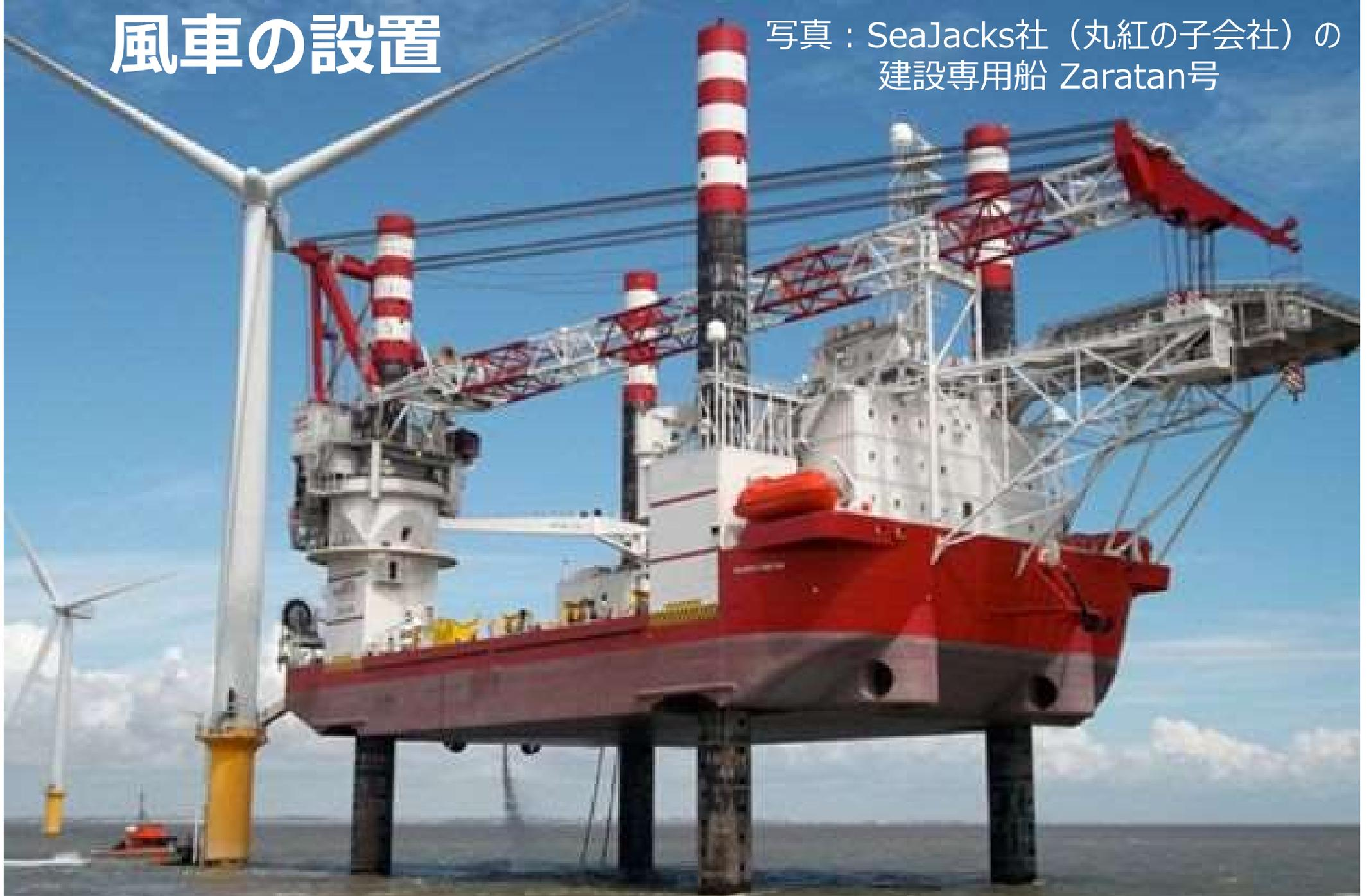
海底まで脚を伸ばして安定できる建設専用船(JUV/Jack-up vessel)で
