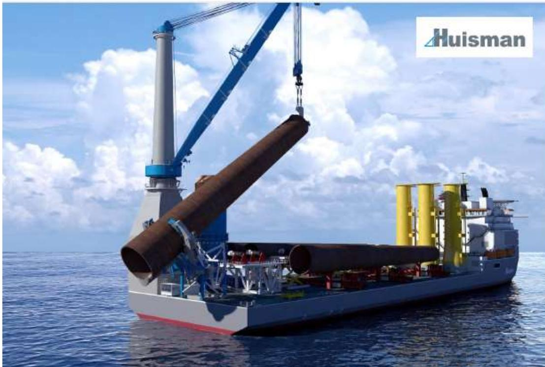
打設時にモノパイルを支える蟹ハサミ状の治具が開発され、垂直度の精度が向上してトランジションピースによる角度補正の必要が小さくなった。
