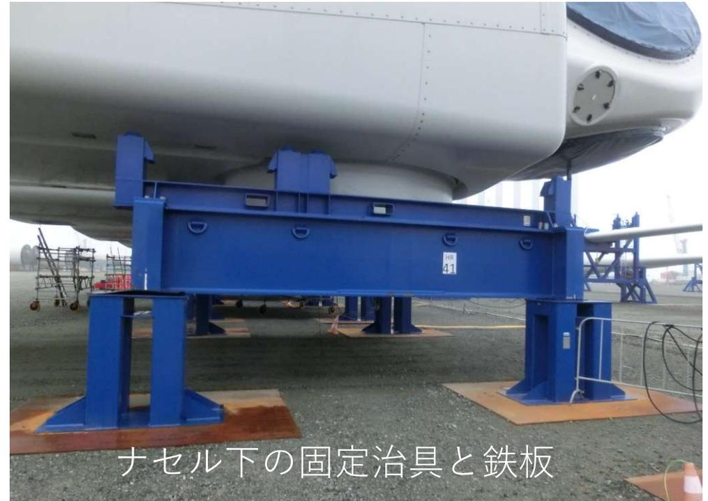
ナセル下の固定治具と鉄板
